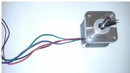
Figura 18 - Motor de Passo. Fonte: do autor.
