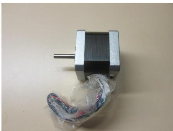
Figura 13 - Motor de passo. Fonte: Mercado Livre (2014b).
