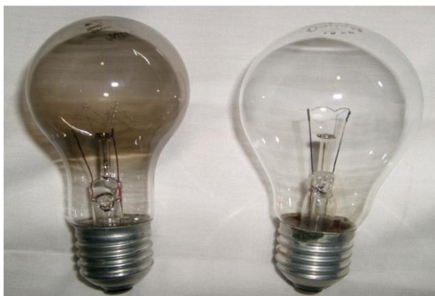
Figura 7 – Depreciação do fluxo luminoso
