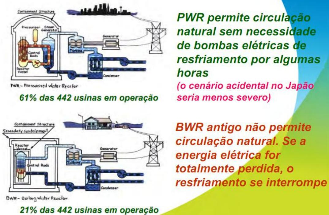
Figura 30: Diferença entre usinas BWR e PWR. Fonte: ELETRONUCLEAR (2011)
