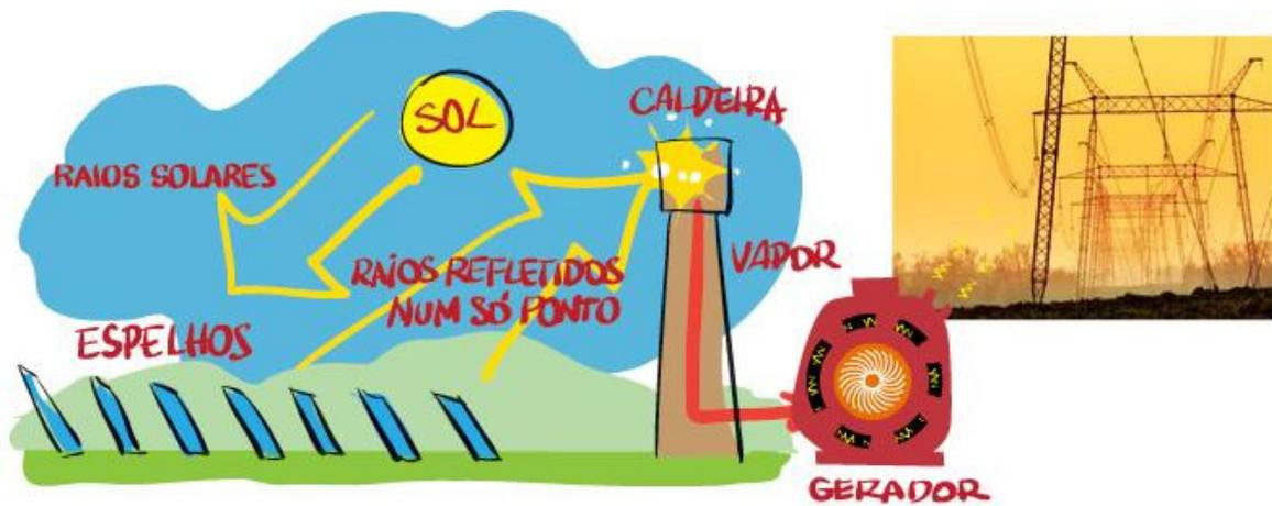
Figura 46: Esquema termosolar. Fonte: ELEKTRO
