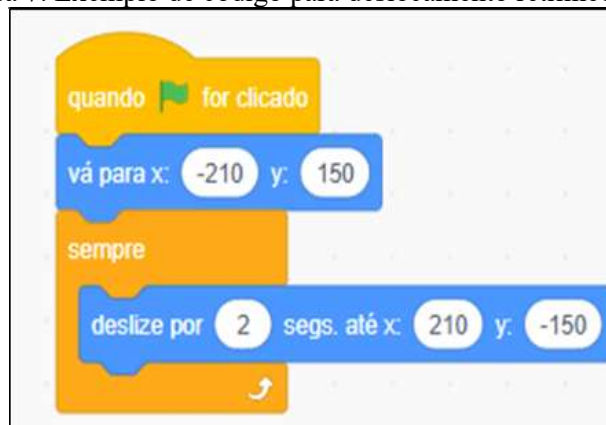
Figura 7. Exemplo de código para deslocamento retilíneo do tubarão
