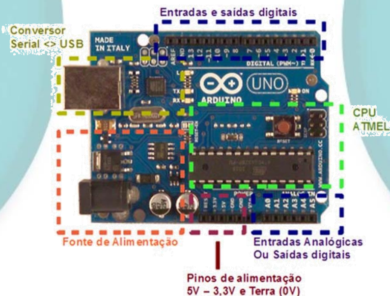
Figura 10 - Blocos identificados de uma placa Arduino Uno Fonte: https://www.embarcados.com.br/arduino-uno/
